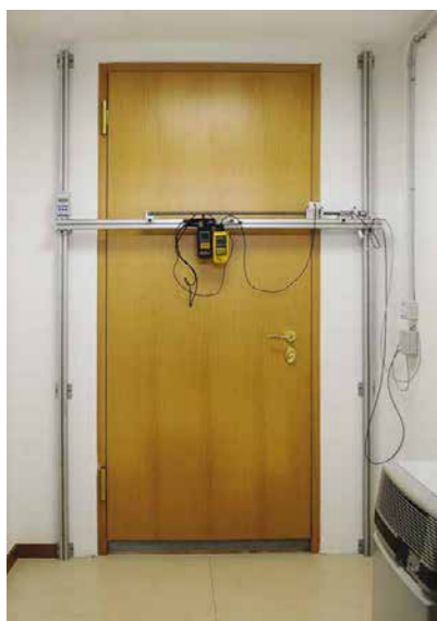
Camera climatica Gasperotti: prove di temperatura con lato esterno porta a -20^{\circ}\text{C} .
