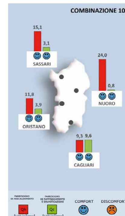
Figura 4 - COMBINAZIONE 10: fabbisogno di riscaldamento, di raffrescamento e deumidificazione, comfort invernale ed estivo
